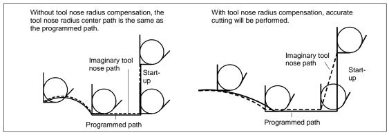
Fig. 5.2.1 (d) Tool path when programming using the imaginary tool nose
