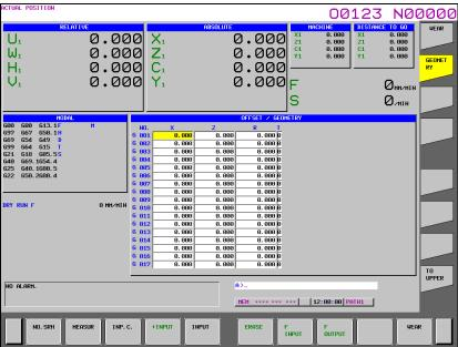
Fig. 2.1.2 (d) Tool offset screen (15-inch display unit)
