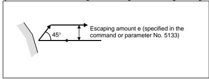
Fig. 4.2.1 (d) Cutting in the direction of 45 degrees (type I)
